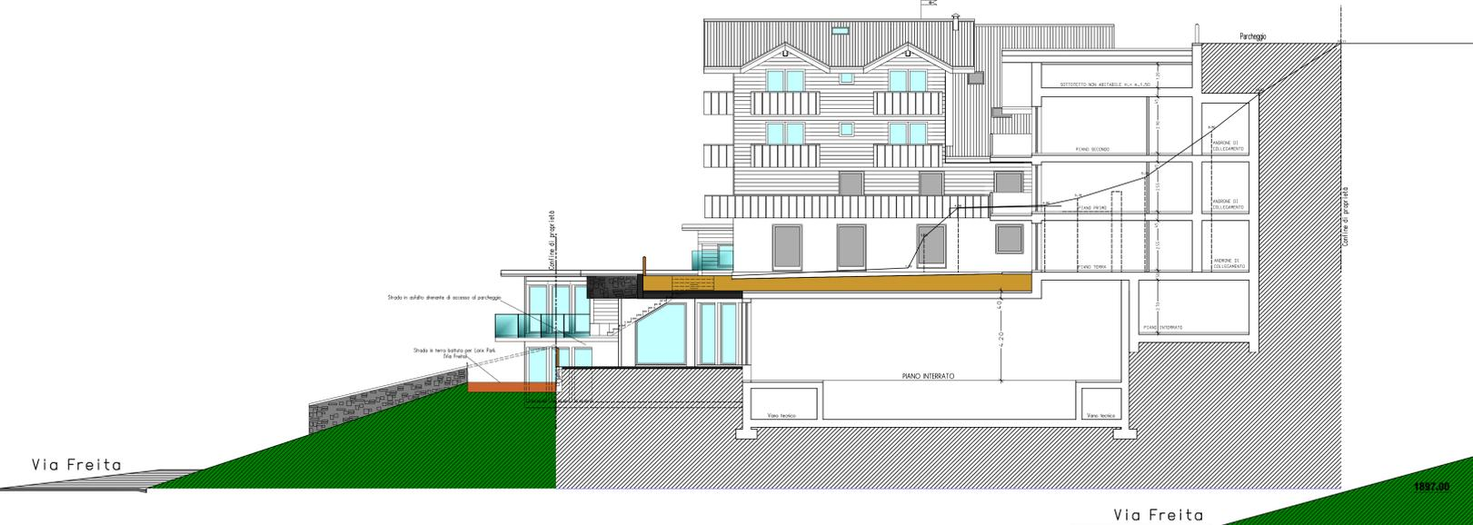
PROSPETTO SUD Sezione A-A Stato di Progetto Scala 1:100
